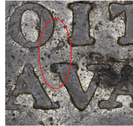
Gambar 4 Permukaan yang berpori hasil kecacatan pada proses pengecoran
